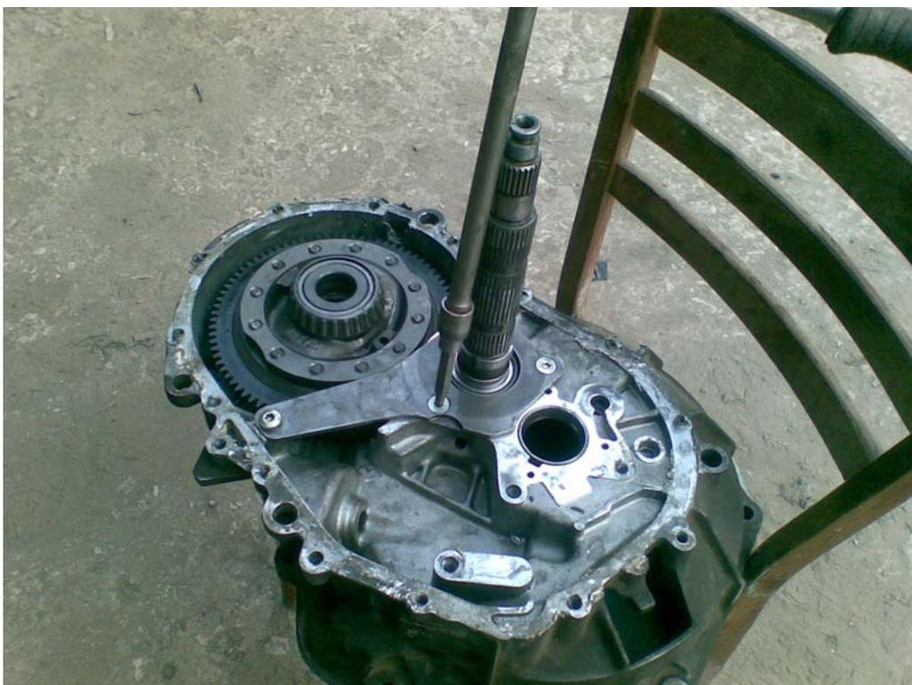
Небольшая сложность со снятием запрессованного на валу подшипника решается просто: (Кстати, эта гайка является регулировочной при сборке, то есть ей зажимается шестерня пятой передачи до упора, если она ослаблена - вторичный вал будет болтаться и стучать при движении, но опять не зажмите вал)
