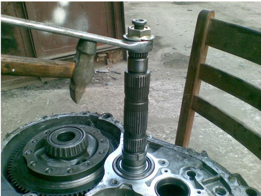
Небольшая хитрость, дифференциал вынимается только в определенном положении, обращаем внимание на совпадение проточки (кстати появился виновник треска в моей коробке - шарик, тот что выскочил у меня при первом моем ремонте, и в итоге хорошо пристроился между корпусом коробки и косозубой шестерней):
