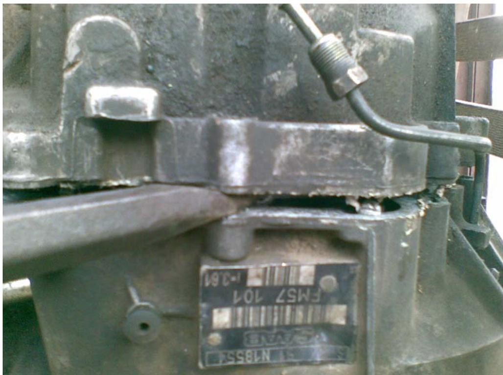
При этом желательно обстучивать вал, крышка коробки снимется намного легче:
