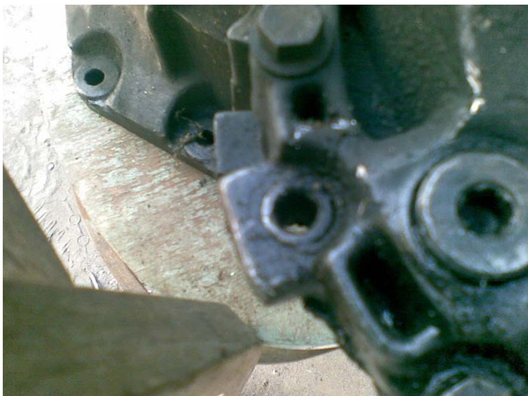
Берем два зубила и начинаем вбивать их между корпусом коробки и колоколом сцепления:
